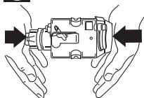
如果很难把萃取器放回机器，则可按压图片中所示的两个操作杆来使它适应正确的尺寸
