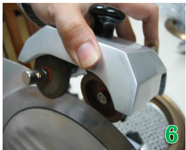
後方為粗磨刀石，按 10-15 秒放開即可 〈有火花、聲音為正常現象〉
