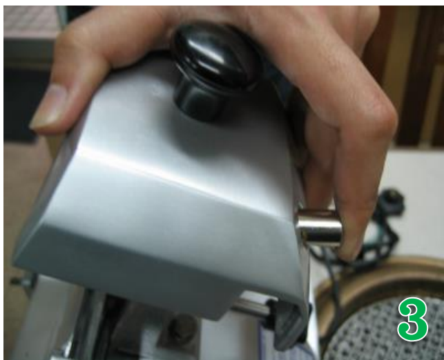
將刀刀至於兩片磨刀石中間 再將後方螺絲做固定
