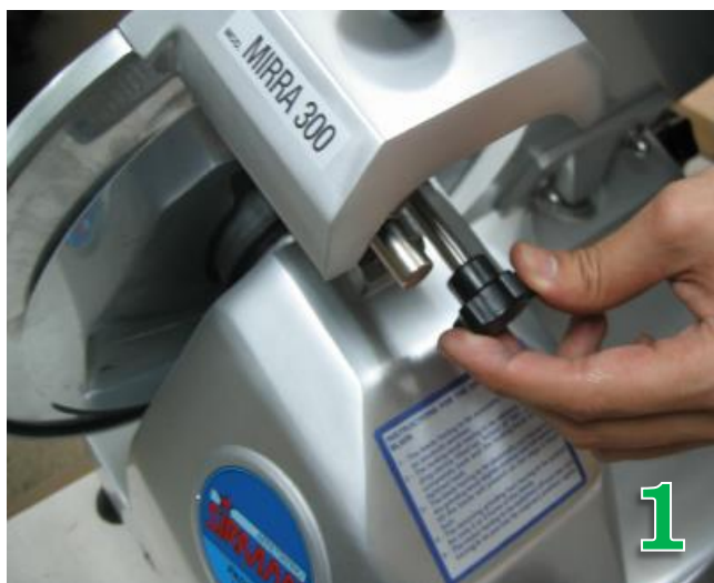
逆時鐘將後方刀盤護蓋螺絲鬆開
