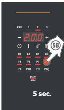
通过选择不同的位置，如 P8，P7 程序将保留其原始设置（即温度 180° C），P8 程序将具有和 P7 程序一样的参数，除了温度 200° C 以外。
