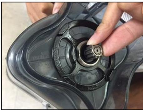
2. 每週或設備噪音異常時檢查傳動座是否磨損或鬆動，如有發現磨損嚴重或聲音變大情形，必須立即報修更換傳動座。
