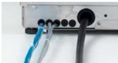
把电源电缆从机器后部穿到前边的接线端子排处
