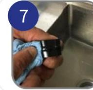
仔細徹底地清潔從機器上拆下的所有墊圈和 O 形環；務必擦拭墊圈和 O 型環以去除多餘的潤滑劑
