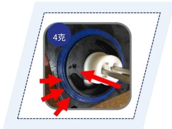
將墊圈 (2) 平放在門背面的凹槽內 ; 將攪拌器導軌 (2) 滑到攪拌器桿 (2) 上 , 使凸緣靠在門上
