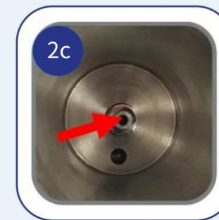
將驅動軸插入氣缸後部的後殼軸承中，然後轉動
