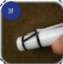
使用 O 型環拆卸工具從出料閥上拆下 O 型環 (4)和 H 形環 (1)
