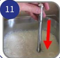
清洗氣管及蓋帽 ;在料斗中安裝氣管 (進氣孔位於氣管底部一側)
