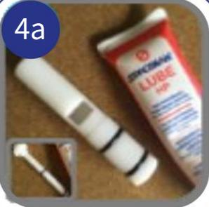
將 O 型環 (4) 放到側排氣閥 (2) 上 ; 將 H 型環 (1) 安裝到中間出料閥 (1) 上 ; 將 O 型環 (4) 放到填料塞 (2) 上 ; 塗抹所有環形區域
