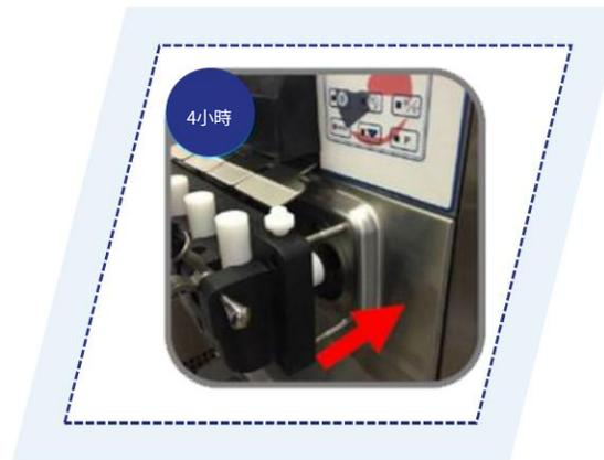
將分配門組件插入汽缸 , 先插入攪拌棒 , 插入時將手把一直往上推
