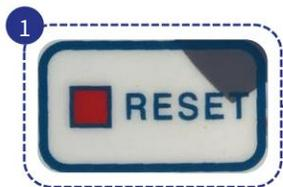
1 按 RESET 鍵停止機器功能。按住RESET 直到顯示幕顯示設定。黏度是顯示的第一個設定；再次按下 RESET（不要按住），溫度將變為下一個。如果您超過了溫度設置，請按“RESET”直到它恢復正常。
