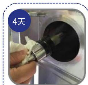
使用乾毛巾從汽缸內部取出驅動軸
