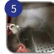
使用提供的刷子、海綿和乾淨的毛巾仔細徹底地清洗從機器上拆下的所有部件
